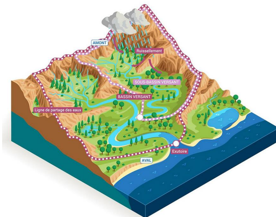
Figure 7 - Représentation schématique d'un bassin versant 19
