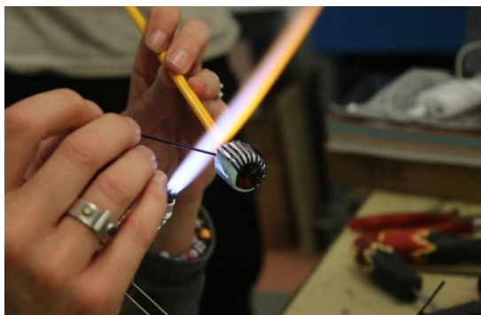
Figure 11 : Technique du verre filé au chalumeau 46
