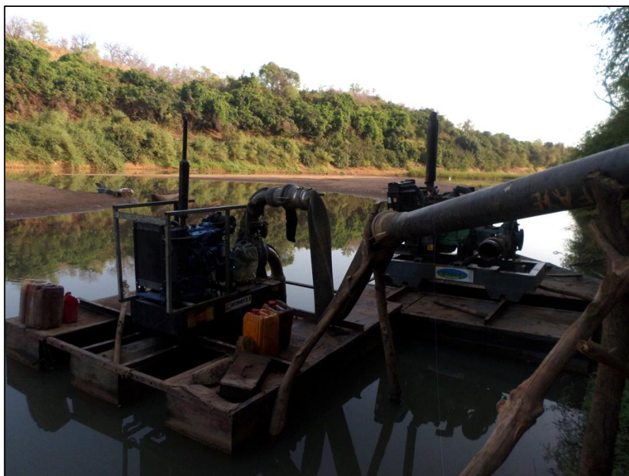
Figure 13 - Un pompage assuré par deux GMP - Lucien, 2025, Nguène 2
